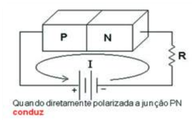
Fig. 27 – Junção P-N em condução
