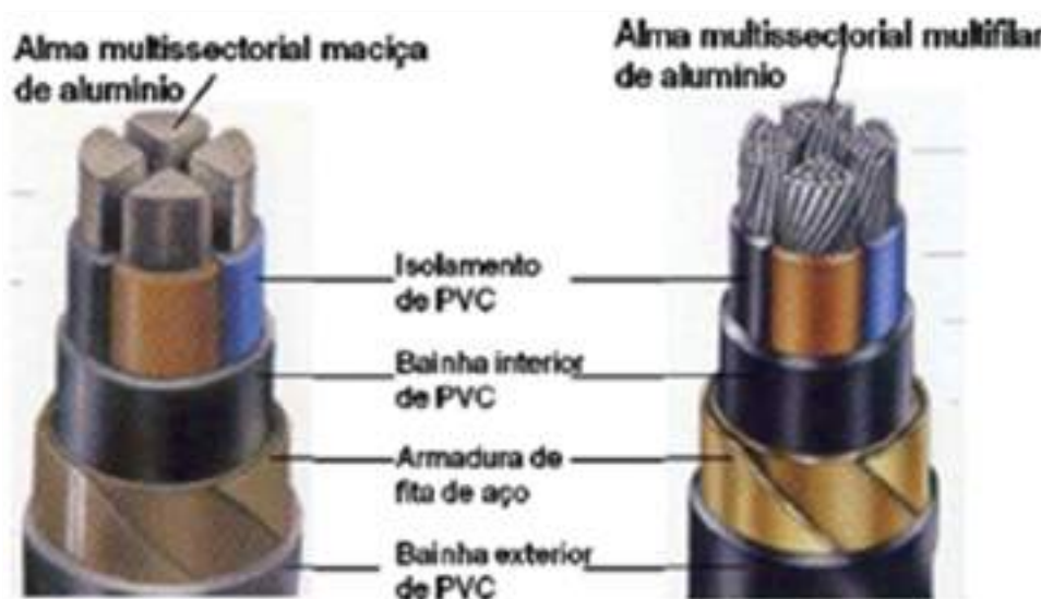
Fig. 44– Exemplos de cabos com diferentes constituições e revestimentos
